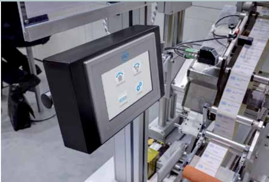
Das ›Easy Touch Control ETC5000‹ an einer Etikettiermaschine der BBK Etikettier- und Sondermaschinenbau GmbH ( www.bbkgmbh.de ). In diesem System ist Siko zufolge das Know-how aus 50 Jahren Formatverstellung in einem Produkt vereint; es bietet somit eine einheitliche und komplette Plug-and-Play-Lösung für OEM-Kunden sowie Nachrüster und Endanwender
